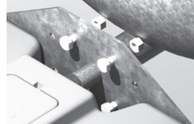
DE Es ist auf ausreichend Abstützung für die Tränke zu achten! Tragfähigkeit des Fassanschlusses prüfen! Min. 4 x Schraube M10 verwenden!
