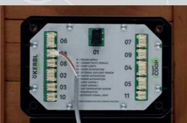
Sollte das am Modul verbaute Anschlusskabel in der Länge nicht ausreichen, so kann es mittels Verlängerungskabel (Art. 70629, 70630) verlängert werden. Achten Sie darauf, dass die Verbindungsstelle vor Wasser und Staub geschützt ist! Das Modulkabel darf max. 1x verlängert werden.
