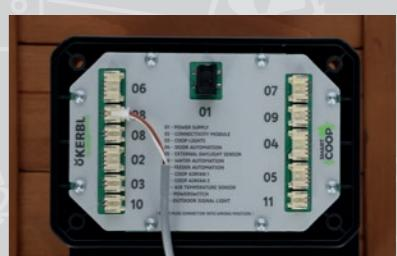
Si la longueur de câble de connexion raccordé au module n'est pas suffisante, servez-vous d'une rallonge (Réf. 70629, 70630). Veillez à la protection du point de connexion contre l'eau et la poussière ! Un rallongement du câble n'est admissible qu'une seule fois.
